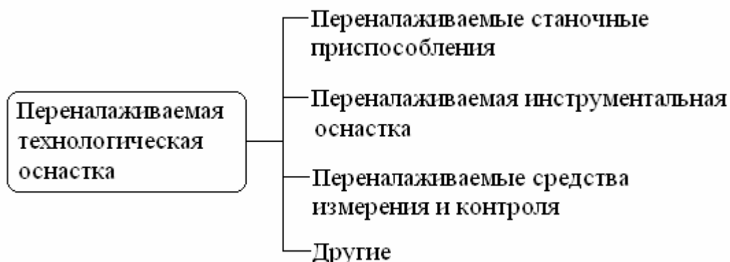
Рис. 1. Состав технологической оснастки металлорежущих станков
