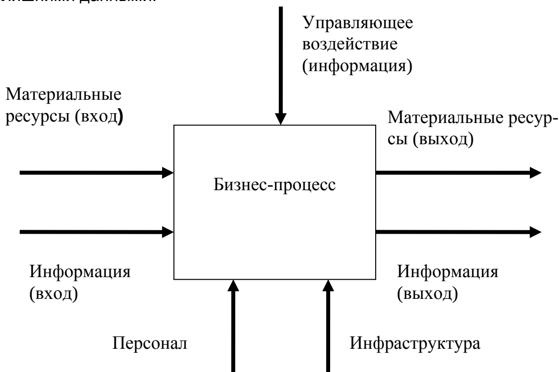
Рис. 1. Функциональный блок IDEF0-диаграммы
