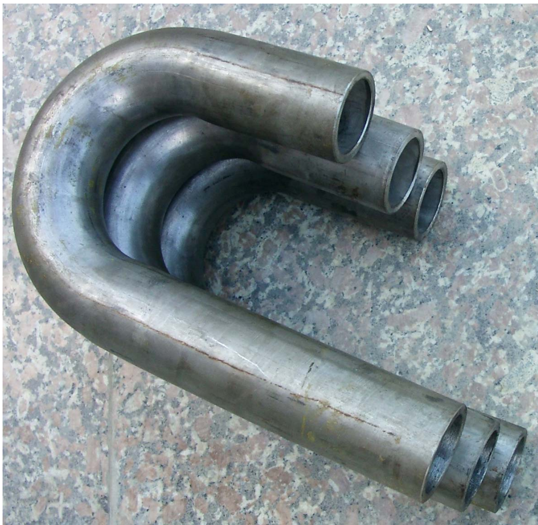
Рис. 2. Фотография изогнутых труб \varnothing 57 \times 5 из стали 12X18H10T
