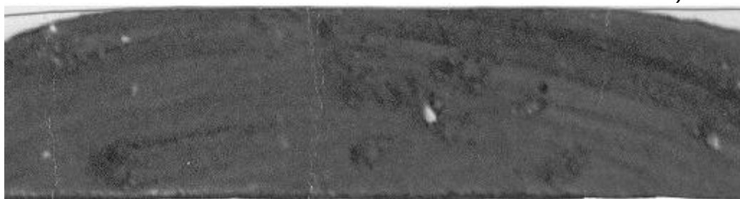
Рис. 5. Состояние поверхностей после обработки фрезерно-шлифовальной головкой
