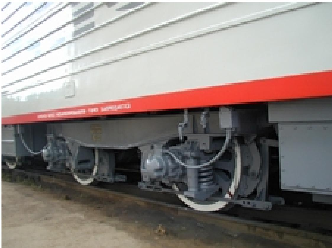
*Рис. 3.25. Механическая часть электровоза ЭП10*
