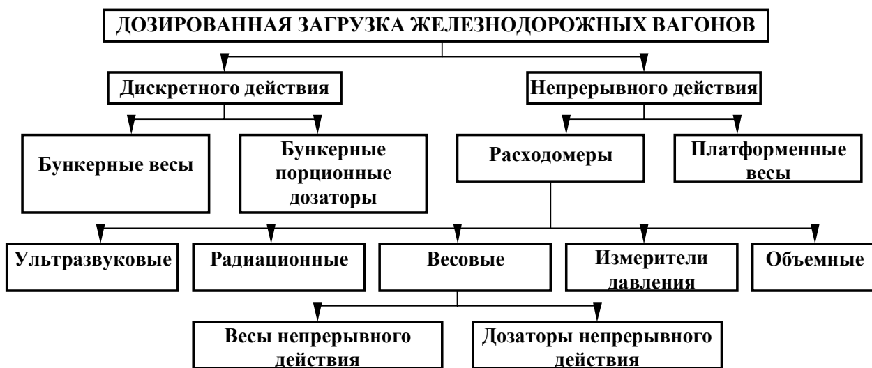
Рис.2.61. Классификация способов дозированной загрузки железнодорожных вагонов
