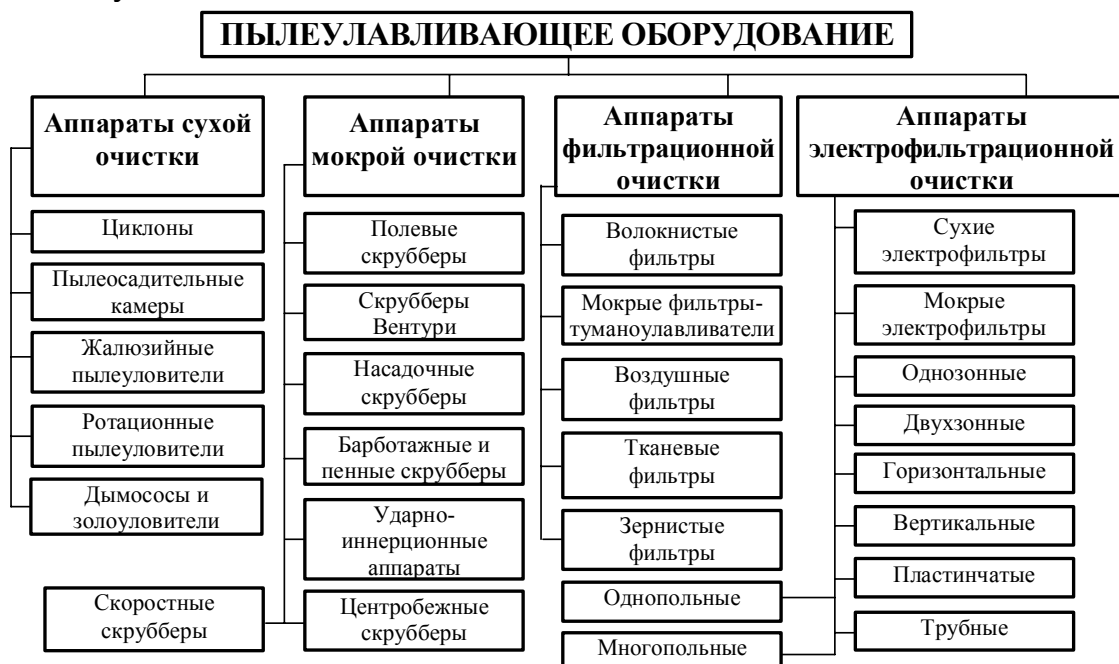
Рис.6.9. Классификация пылеулавливающего оборудования
