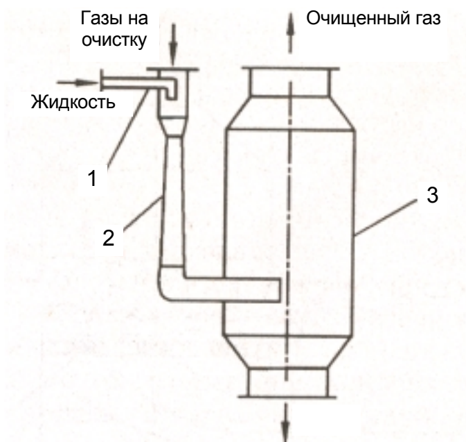
Рис.6.16. Скруббер Вентури: 1 - орошаемая фарсунка; 2 - труба Вентури; 3 - каплеуловитель
